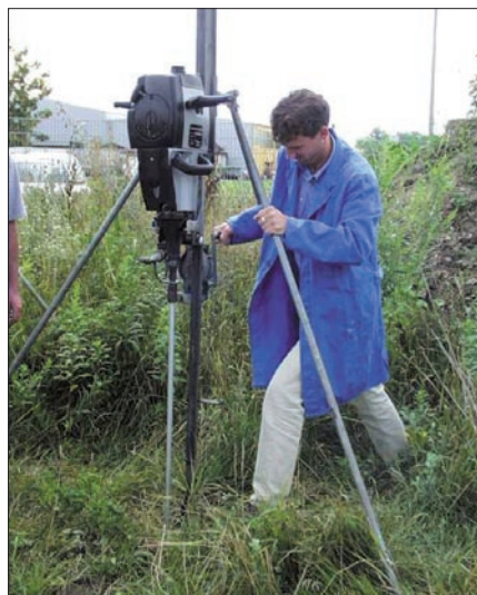
Obr. 14. Trojnožka pro zatlučování hloubkových zemničů
