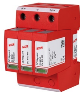
DEHNguard MYPV SCI je svodič přepětí se zkratovacím mechanismem, který brání zahoření při odpojení varistoru.
