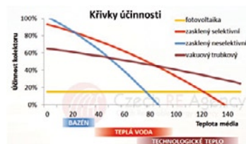
Obr. 1: Závislost účinnosti na teplotě média při standardních podmínkách pro testování fotovoltaických panelů (teplota okolí 25 °C, intenzita záření 1000 W/m 2 )
