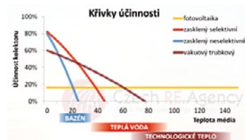
Obr. 2: Závislost účinnosti na teplotě média při teplotě okolí 0 °C a intenzitě záření 400 W/m 2
