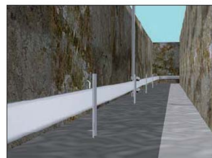
Obr. 3. Zemnicí pásek uložený na vymezovacích vzpěrách
