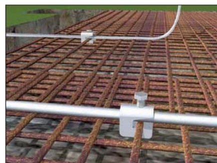
Obr. 9. Svorky pro jednoduché připojení armovacích prutů
