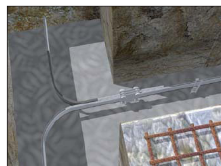
Obr. 4. Vývod pro připojení svodu opatřený izolací
